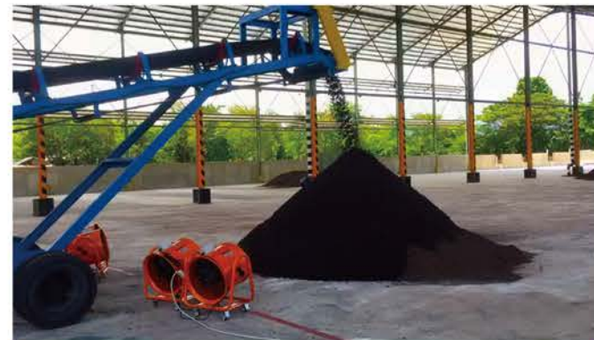
⑥ 左ホッパーから、コンベアー使用して、落差を作り強力風力機で、ファイバー、粉じん等を飛ばし。次の工程
