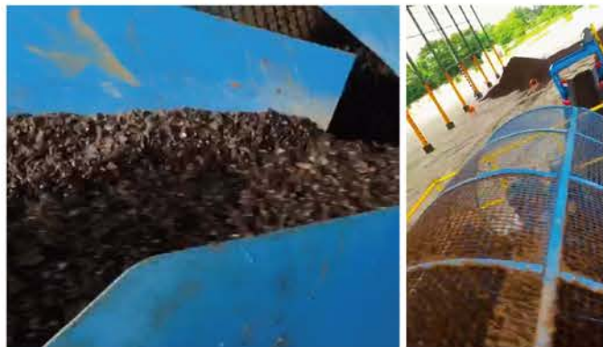
④ 2回目の製錬此处では、細かいごみ、粉等を排除して風力自然乾燥
